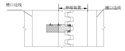
图 1 作用于梳齿板的轮载
